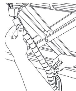
Empurre a abraçadeira de cabos na ferramenta de abraçadeira de cabos.
